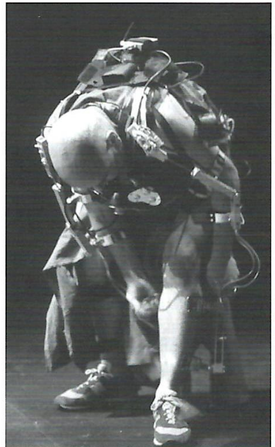
Dresskeleton utilisé par Marcel.Ií Antúnez Roca depuis 1998 et conçu spécialement pour lui. Il s'agit d'un appareillage à vêtir composé de l'interface corporelle des capteurs de mouvement et d'interrupteurs manuels.
